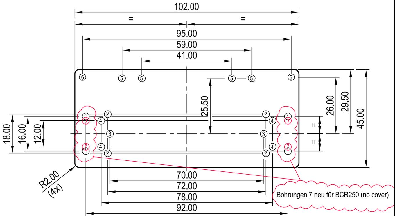
Bohrungen 1-5 sind Durchgangsloecher fuer die Befestigung der Lese-Geraete im Deckel. Ø3.2mm
